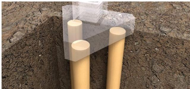
Foto 4 - Ilustração de elementos de fundação.
