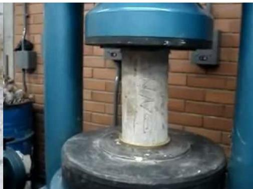
Foto 2 - Teste de compressão do concreto.
